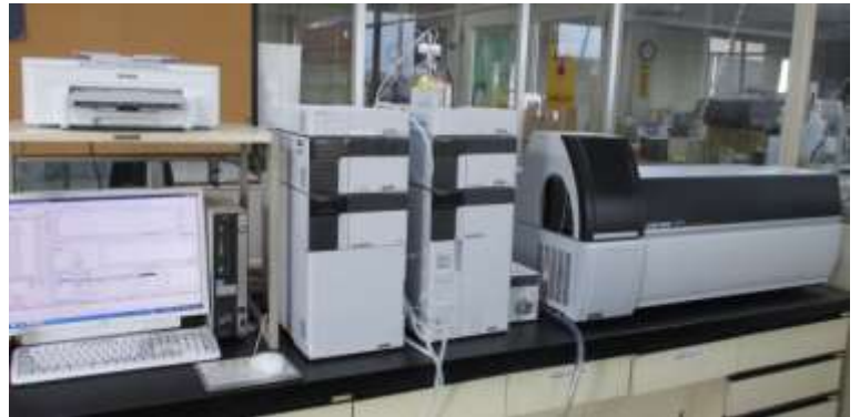
【液体クロマトグラフ・タンデム型質量分析計 (LC/MS/MS) SHIMADZU LCMS-8040】
